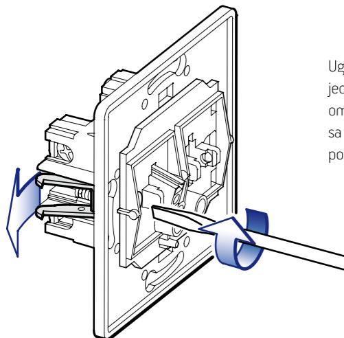
Ugradnja pomoću stegića je brza i jednostavna zahvaljujući rešenju koje omogućava pritezanje stegićem sa vrlo malo okretaja izvijača i bez potrebe jačeg pritezanja vijka.
